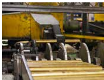
Las barras se cortan en la longitud deseada
