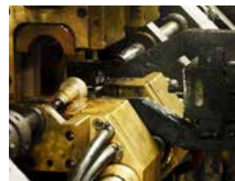
El vástago se calienta eléctricamente y se empuja para crear el collarín de empuje
