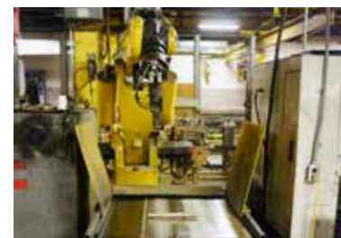
Las roscas del vástago y el collarín de empuje se fresan y se ordenan robóticamente
